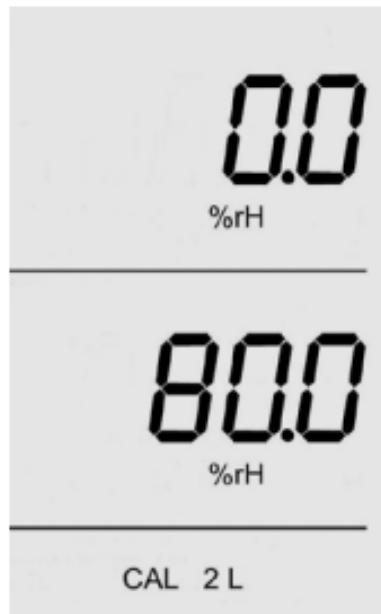
**CAL2:** Mit CAL2 (Einpunktikalibrierung) stellt man den Offset für Sensor 2 (rel. Feuchte) ein. Der Offset dreht die Kennlinie um den unteren Abgleichpunkt (11 % r.H.). Der Abgleichpunkt muss im Bereich von 30 % ... 95 % r.H. liegen. Der Offset wird im oberen Teil des Displays angezeigt. Maximal lassen sich  $\pm 10$  % r.H. einstellen. CAL2 ist nur in der Verbindung mit der Einheit % r.H. wählbar.
