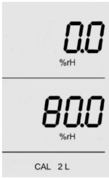
**CAL2:** Con CAL2 (calibración en un punto) se establece el offset para el sensor 2 (humedad relativa). El offset gira sobre el punto de ajuste inferior (11 % h.r.). El punto de compensación debe estar en el rango de 30 %...95 % h.r. El offset aparece en la parte superior del display. El máximo offset está en  $\pm$  10 H.R. CAL2 sólo puede seleccionarse con la unidad % H.R.
