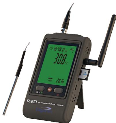
La serie di Datalogger GSM Temperatura ed Umidità può trasmettere automaticamente i dati di temperatura ed umidità in tempo reale sul PC di un utente dotato di software TronFlux per mezzo di una rete GPRS; nel frattempo, tutti gli altri utenti hanno la possibilità di scaricare i dati in remoto mediante un qualsiasi browser web.
