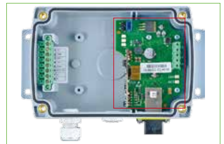
Ethernet - Modbus TCP
